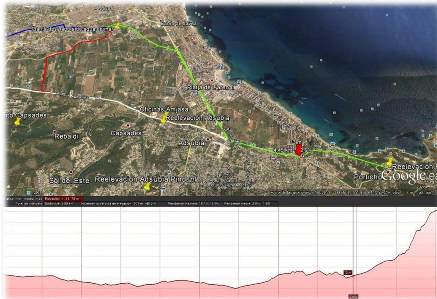
*Desnivel en el punto señalado (flecha roja- línea vertical) con perfil del terreno en tramo IDAM -Portitxol.
